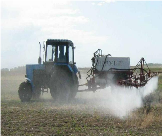
شکل ۸-۱۲ بادبردگی و تلف شدن سم به دلیل ارتفاع نامناسب بوم و نازل‌های نامناسب .
