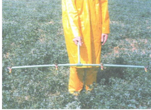
شکل ۳-۸ بوم قابل استفاده با دستگاه سمپاش کتابی پشتی (اقتباس از فلاح‌جادی، ۱۳۸۴).
