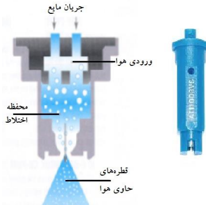
شکل ۷-۹ نمای کلی نازل القاءکننده هوا.
